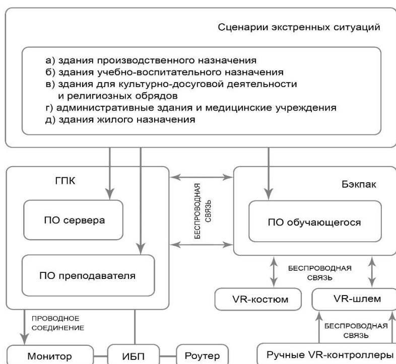
Рис. 2. Схема структуры VR-тренажера с учетом опыта его применения для пожарных-спасателей 1
