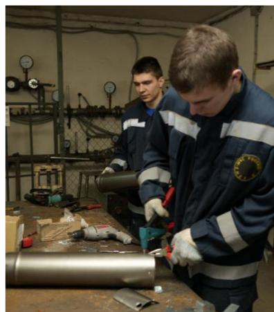
**Рис. 2.** Изготовление окопных свечей и рабочая бригада переносной печи
