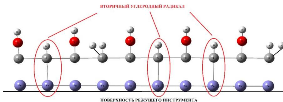
Рис. 6. Схема образования металлополимерных соединений в зоне трибосопряжения металлических поверхностей в присутствии активированного СОТС с кислородсодержащими полимерными присадками
