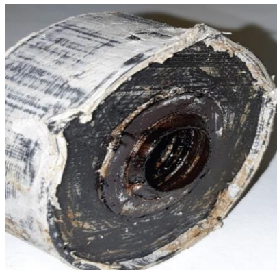
Рис. 5. Образец уплотнительного устройства с пробоем магнитных эластомерных шайб
