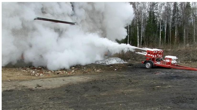
**Рис. 3.** Подача порошка от мобильного комплекса (5 с)
