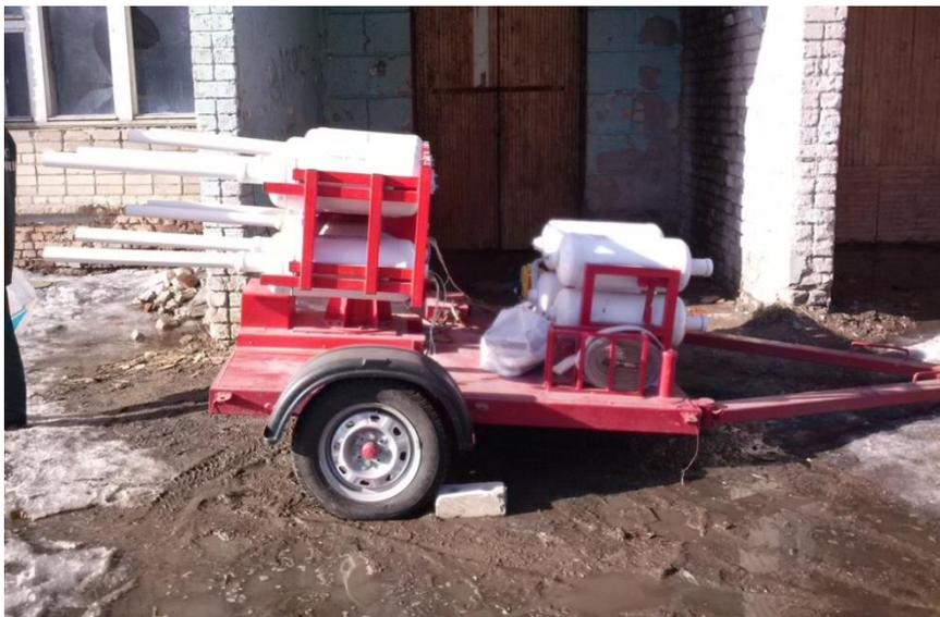
**Рис. 1.** Мобильный комплекс порошкового пожаротушения «Гранит» с МПП «Тунгус»
