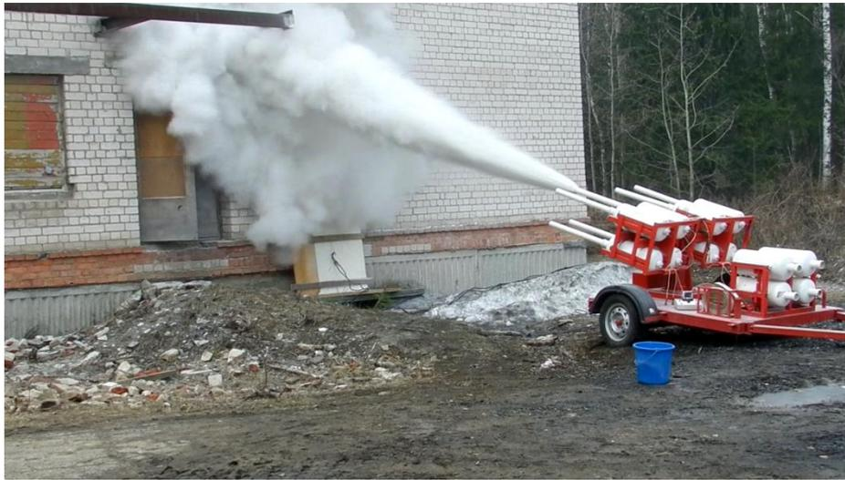
**Рис. 4.** Отклонение струи порошка при выбросе из МПП Тунгус-24 (на 3 с подачи)
