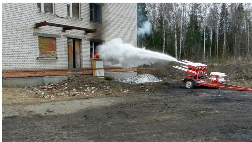
**Рис. 2.** Подача порошка от мобильного комплекса (на 1 с)
