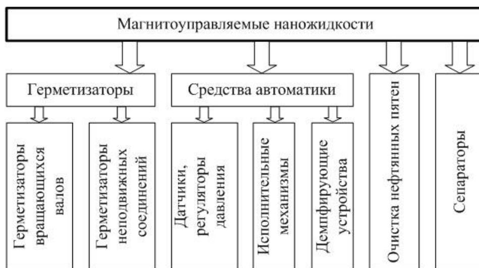
**Рисунок.** Основные виды и направления использования наноматериалов в аварийно-спасательной технике
