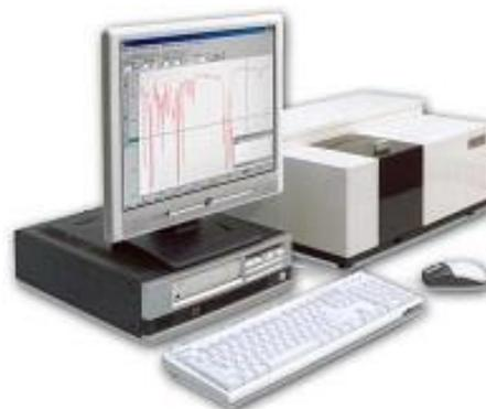
**Рис. 1.** Внешний вид инфракрасного Фурье-спектрометра ФСМ 1201
