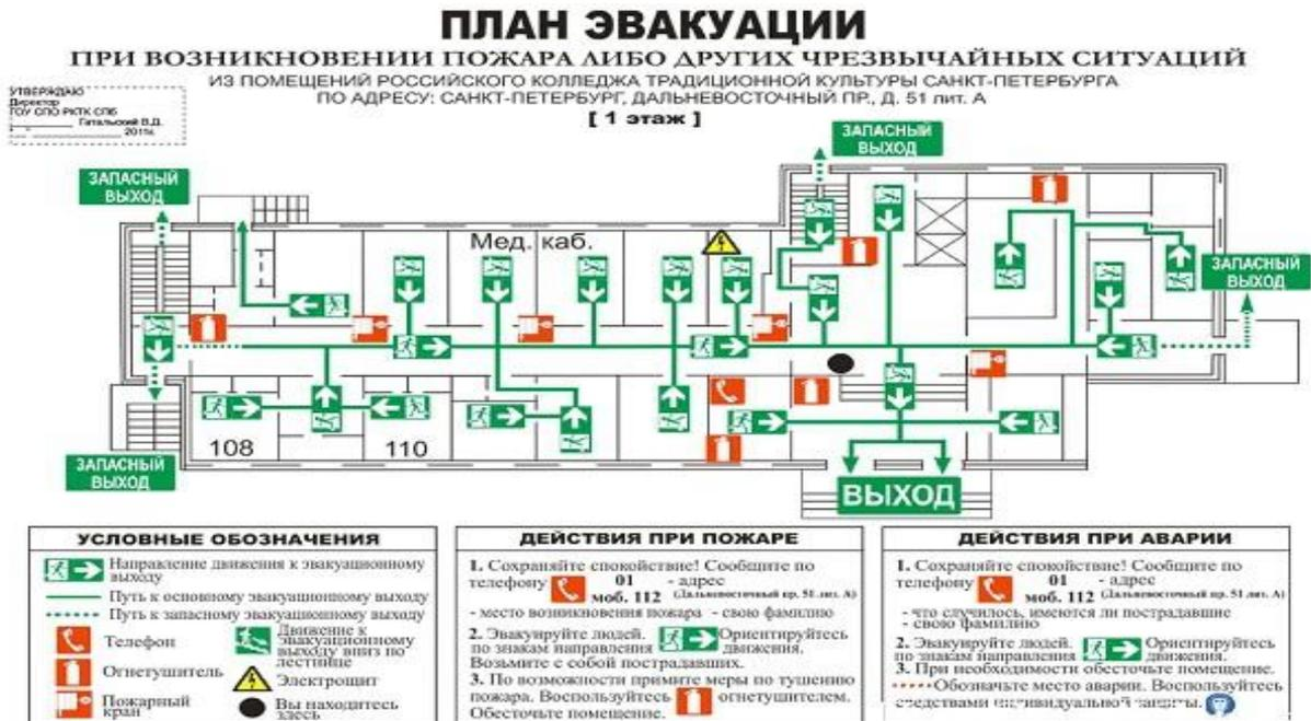
Рис. 2. План эвакуации людей при пожаре в здании колледжа
