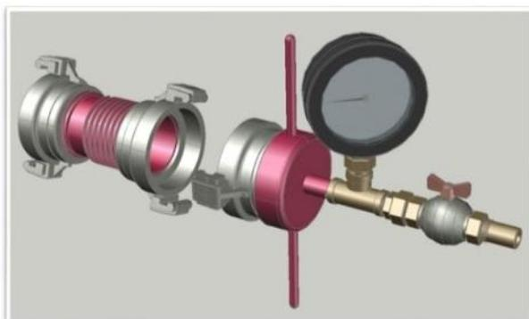
3D модель устройства для испытания пожарных рукавов
