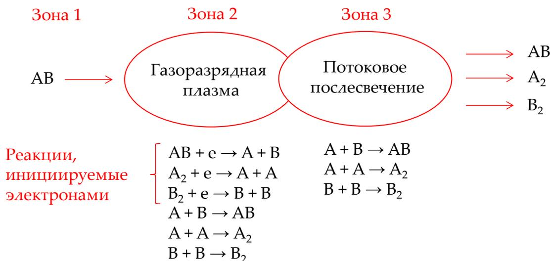
**Рис. 2.** Принципиальная схема простейшего (монореагентного) гомогенного плазмохимического процесса
