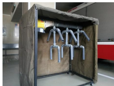
Рис. 3. Экспериментальный образец сушильной камеры СЗО пожарного
