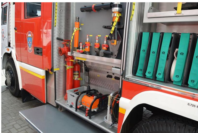
Рис. 1. Расположение гидравлического аварийно-спасательного инструмента в отсеке пожарного автомобиля
