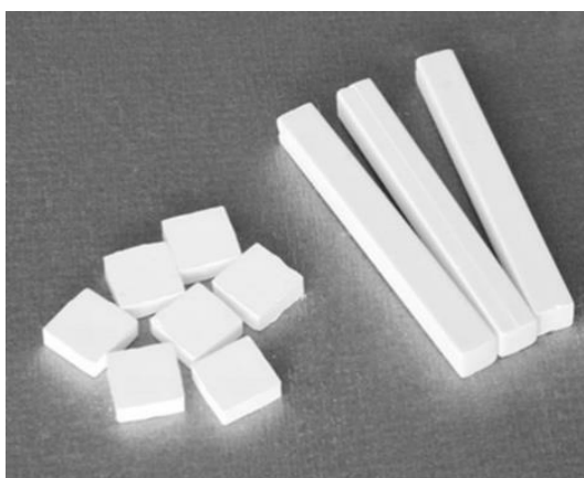
Рис. 2. Образцы для определения трибологических и прочностных свойств керамического материала
