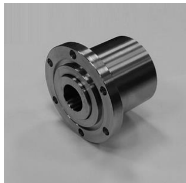
Рис. 2. Экспериментальный образец МЖУ
