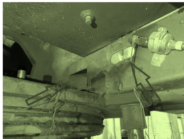
Рис. 6. Технологические отверстия в поворотной платформе (отмечены стрелками)
