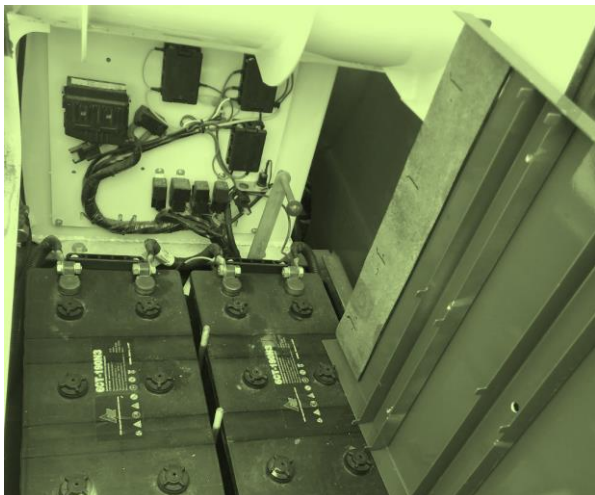
Рис. 12. Фото защитно-фиксирующей крышки АКБ экскаватора аналогичному сгоревшему
