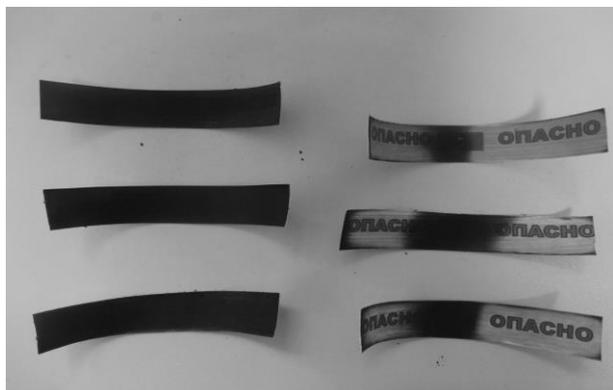
**Рис. 2.** Внешний вид термохромного стикера
